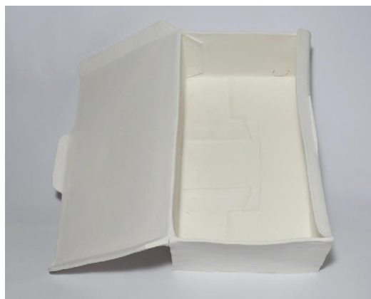
תמונה 25 קופסת הנעליים מפיפר קליי עם תומך למכסה - אחר שריפה ל1100, מראה צד (ימין), קופסת הנעליים מפיפר קליי, מראה עילי (שמאל)
