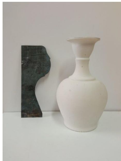
תמונה 29 מודל מגבס שהוכן במחרטה (ימין), מודל הדו-ממד העשוי מלוח ברזל (שמאל)
