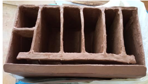
תמונה 20 קירות פנימיים בתוך מבנה הקופסא כדי למנוע בטון או קריסה של המכסה בשריפה (ימין), תווית שהוכנה מטכניקת הלייזר (שמאל)
