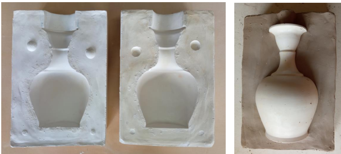
תמונה 30 מודל מגבס מוכן להכנת תבנית (ימין), התבנית הגמורה (שמאל)
