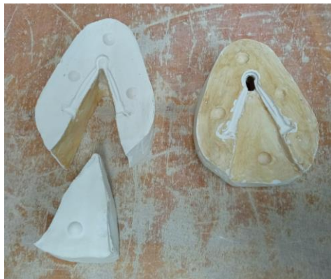
תמונה 9 הכנת מהדק חבל טבור לתבנית (ימין), תבנית שלושה חלקים עבור מהדק חבל טבור (שמאל)
