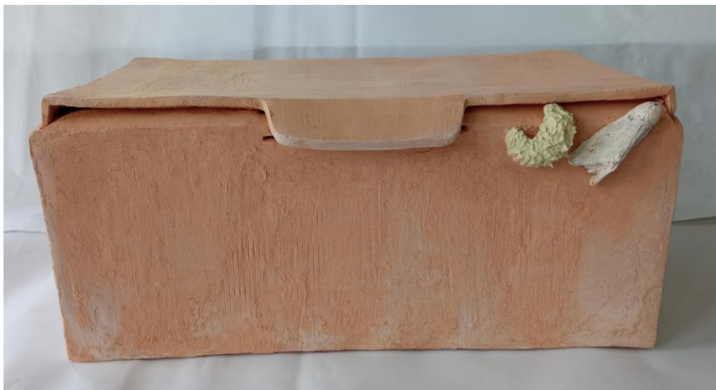
תמונה 22 הקופסא מחומר אבנית לאחר שריפת בייסק (950 מעלות)
