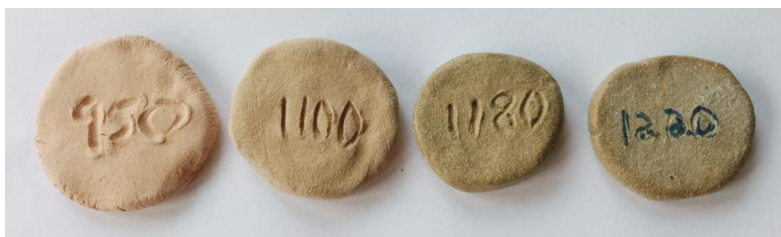
תמונה 23 טסטים של החומר ממנו עשוי קופסת הנעליים - 75% קפה סינקו + 25% בלק מאונטיין
