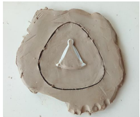
תמונה 9 הכנת מהדק חבל טבור לתבנית (ימין), תבנית שלושה חלקים עבור מהדק חבל טבור (שמאל)
